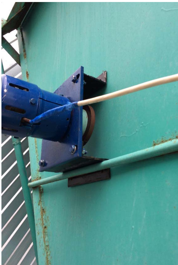
Рис.6.4 – Производственные испытания ЛЭМД-привода устройства для сводообрушения в крестьянско-фермерском хозяйстве ИП «Глава КФХ «Пасечный Андрей Иванович
