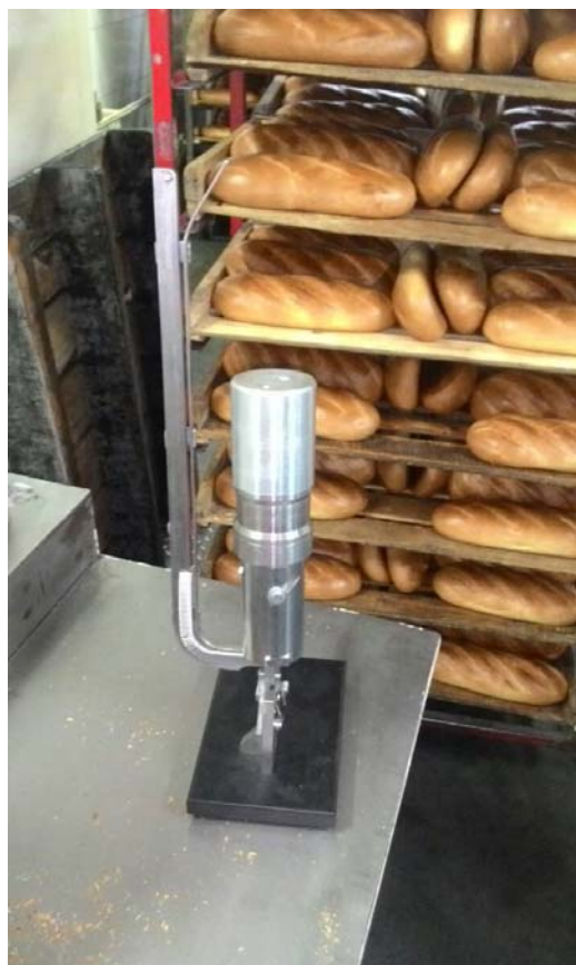
Рис.6.1 – Производственные испытания ЛЭМД-привода устройства клипсования упаковки сельхозпродукции на предприятии ОАО «Знак Хлеба»
