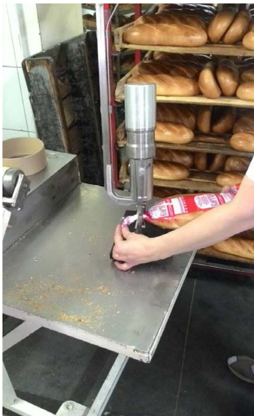
Рис.6.1 – Производственные испытания ЛЭМД-привода устройства клипсования упаковки сельхозпродукции на предприятии ОАО «Знак Хлеба»
