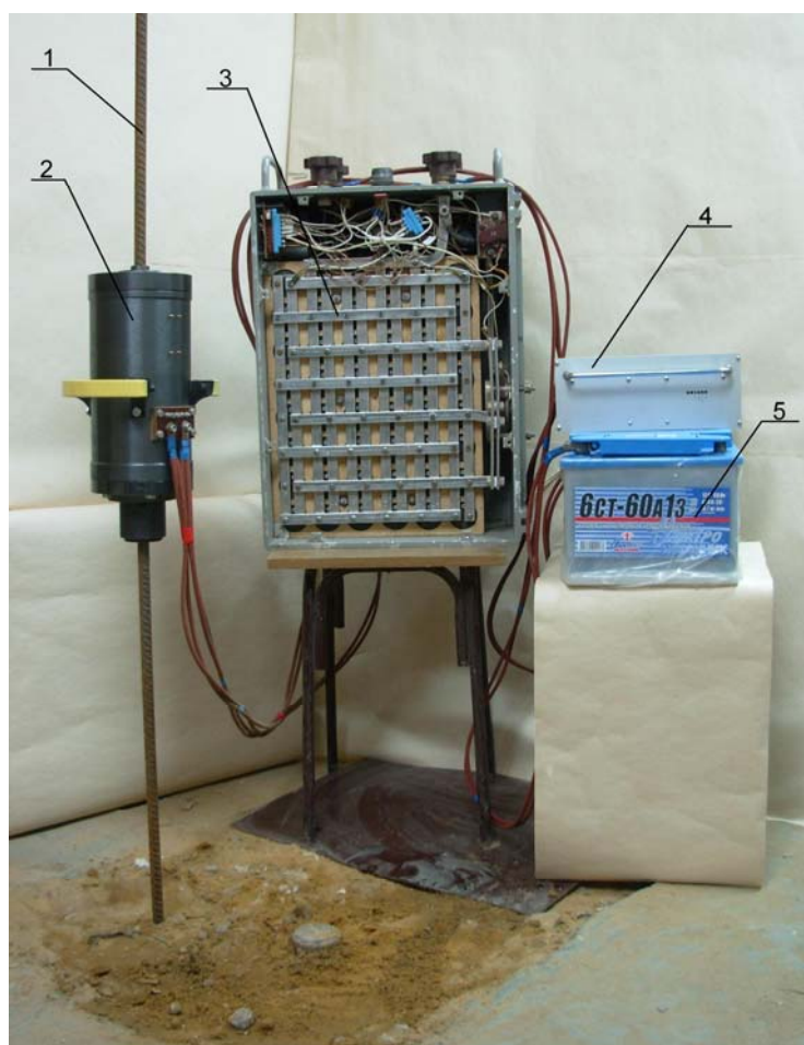
Рис.5.2 – Общий вид физической модели для исследования ударных ЛЭМД-приводов: 1 – погружаемый стержневой элемент, 2 – ударная машина с линейным электромагнитным двигателем, 3 – электрический преобразователь, 4 – DC/DC-преобразователь, 5 – автономный (аккумуляторный) источник.
